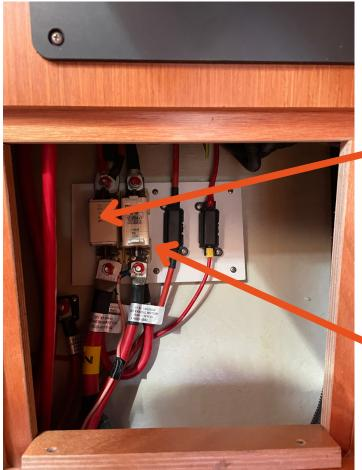
Sinistra: fusibile batteria servizi Left: Battery service fuse
